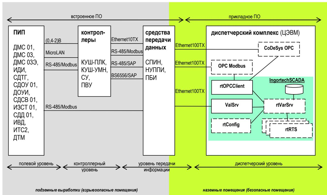
В качестве ПО OPC Modbus сервера используется ПО «Lectus Modbus OPC/DDE сервер» (исполняемый файл «ServOPC»), которое может быть заменено аналогичным ПО, соответствующим требованиям документа «OPC Data Access Custom Interface Specification 2.05A».
